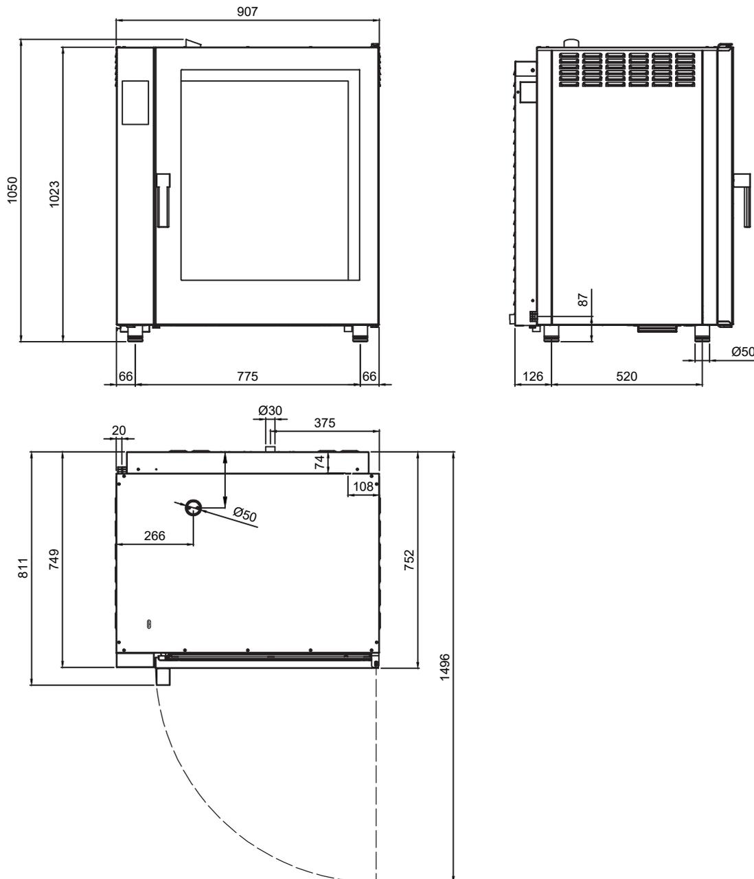
Four électrique à convection version renforcée Cuisson directe à la vapeur Écran tactile couleur Porte battante à droite 10x GN 1/1
